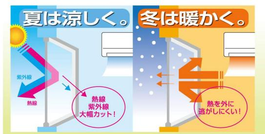
ガラス用透明遮熱塗料はガラス面に塗るだけで太陽光から紫外線を98.0%、熱を60%以上カットすることができます。そのため、夏は窓の外から進入するを抑え、冬は室内の熱を逃しにくくします。省エネしながら、夏は涼しく冬は暖かな快適環境をつくれます。
